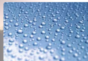
施工後の撥水性能
