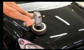
微粒子コンパウンドで塗装表面をフラットに仕上げます。
