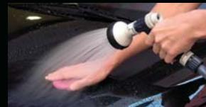
塗装に鉄粉・塗装ミストが付着している場合、ねんど状クリーナーで除去します。
